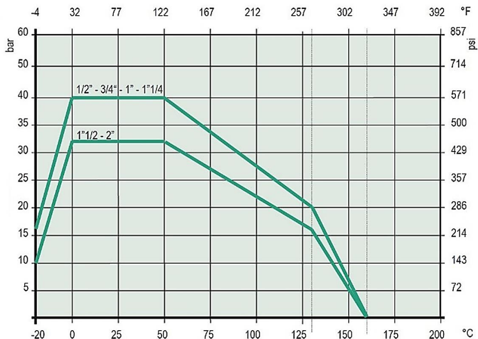
РИС.1.1. ЗАВИСИМОСТЬ РАБОЧЕГО ДАВЛЕНИЯ ОТ ТЕМПЕРАТУРЫ ПЕРЕМЕЩАЕМОЙ СРЕДЫ
